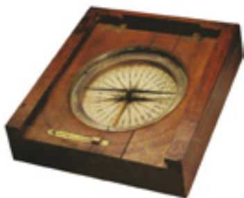
Brújula. Instrumento que sirve para orientarse gracias a una aguja imantada que siempre apunta hacia el norte.
